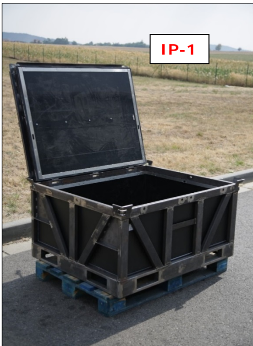
Fig. 8. "MetroDecom" container IP-1
