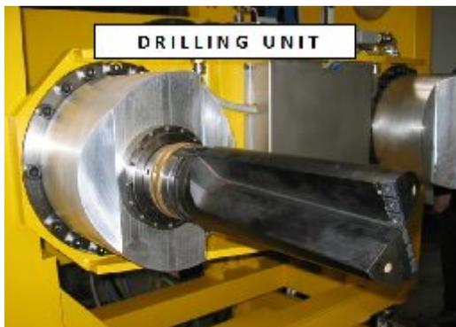
Fig. 6 Drill rod  $\varnothing$  110 mm
