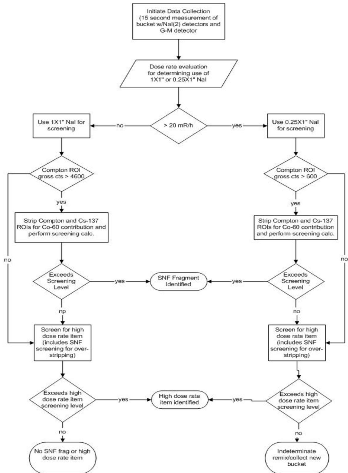
Fig. 12. Screening Logic Diagram
