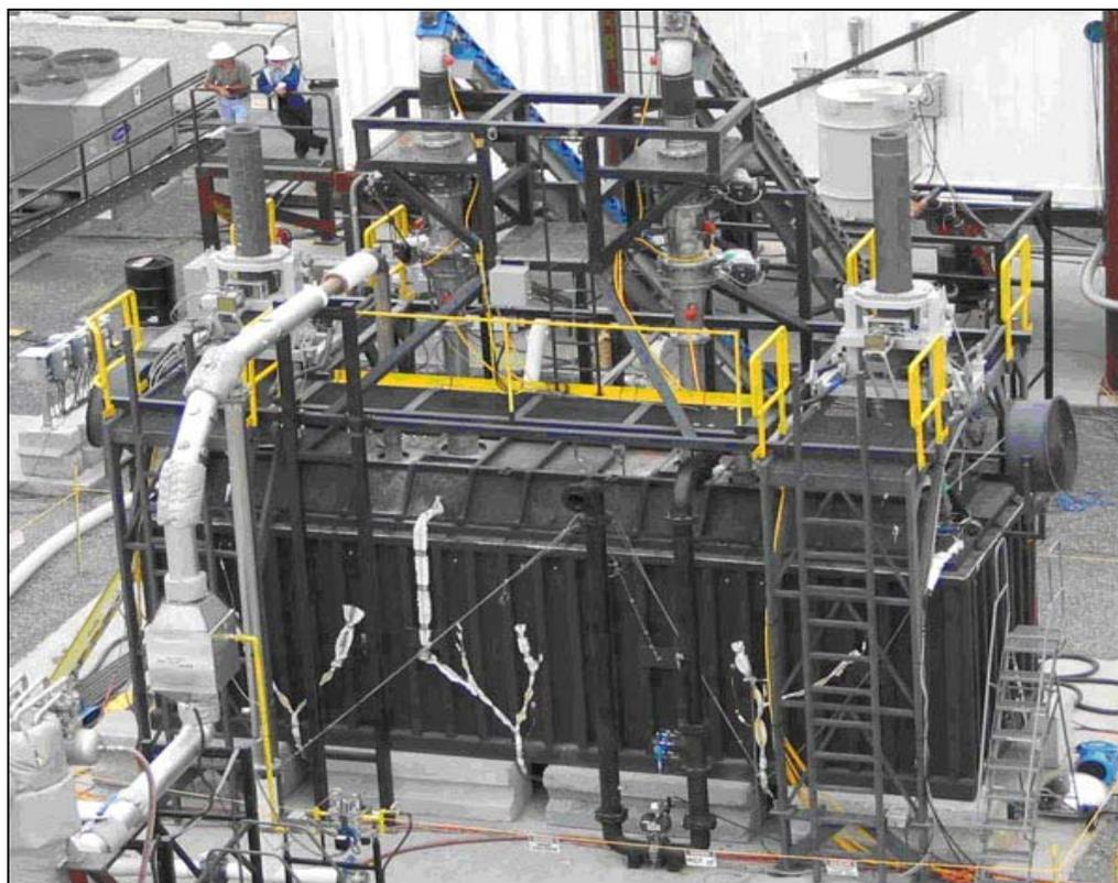
Fig. 4 GeoMelt<sup>®</sup> full-scale ICV<sup>™</sup> melter.
