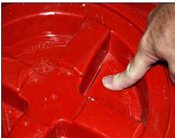
Fig. 16. Cracked bucket lid.
