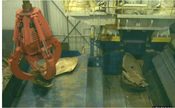
Fig. 2. BNG America-ETTP Supercompactor
