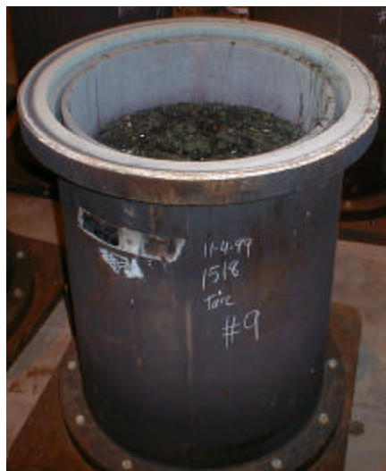
Fig. 3. Example of pour mold containing glassy slag: Batch B9
